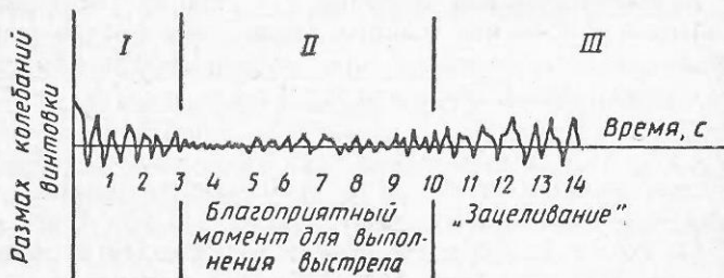
Рис. 120. Схематическая запись колебания оружия при выполнении выстрела (по А. А. Юрьеву):
